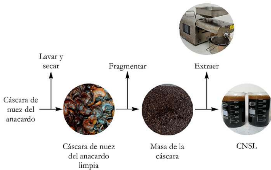
Figura 5. Diagrama de flujo para la extracción del CNSL
