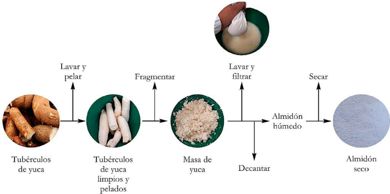
Figura 4. Diagrama de flujo para la extracción del almidón a partir de la yuca
